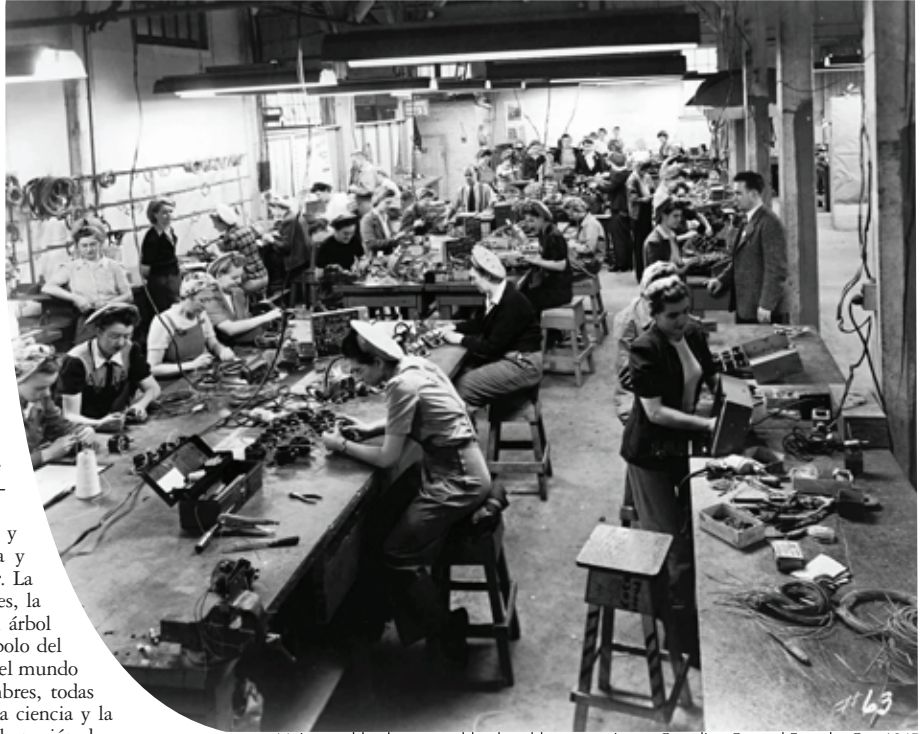
Mujeres soldando y ensamblando cables para aviones. Canadian Car and Foundry Co., 1945
